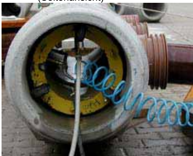
Bild 12: Versuchsaufbau zur Abwinklung (Seitenansicht)
