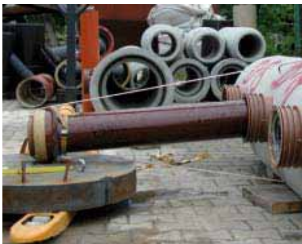
Bild 12: Versuchsaufbau zur Abwinklung (Seitenansicht)
