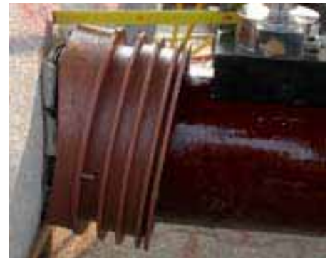
Bild 26: Stutzen nach 15 min aufgebrachtener Kurzzeitscherlast
