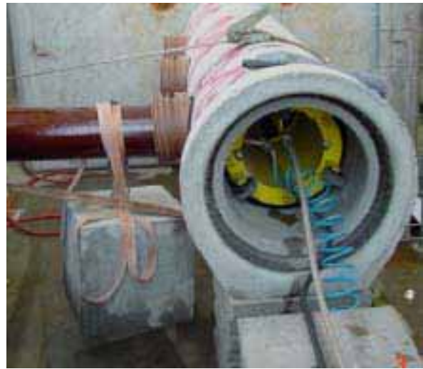
Bild 17: Versuchsaufbau der Langzeitscherlast
