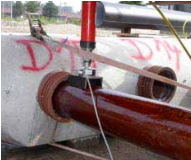
Bild 16: Versuchsaufbau der Kurzzeitscherlast
